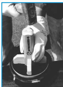
3. Вводят сжимающую втулку забиванием (набор FlexoSet).
